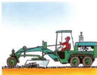
Humectación, perfilado y mezclado
