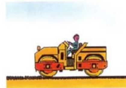
Mezclado suelo /agua/ emulsión y compactación de la mezcla
