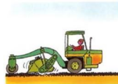
Mezclado suelo /agua/ emulsión y compactación de la mezcla
